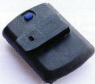
Obr. 10. Zadní strana krabičky s „vytisknutým“ držákem
