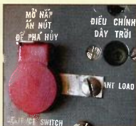
Obr. 78. Detail destrukčního tlačítka u transceiveru TR-20
