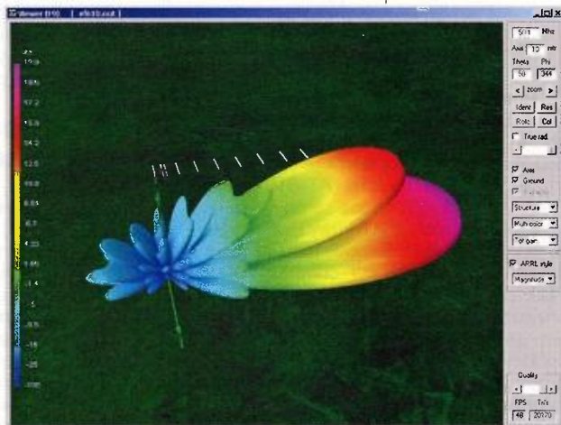
Obr. 2. Ukázka 3D vyzařovacího diagramu 10prvkové antény Yagi pro 50 MHz, vytvořeného a prezentovaného v programu 4NEC-2
