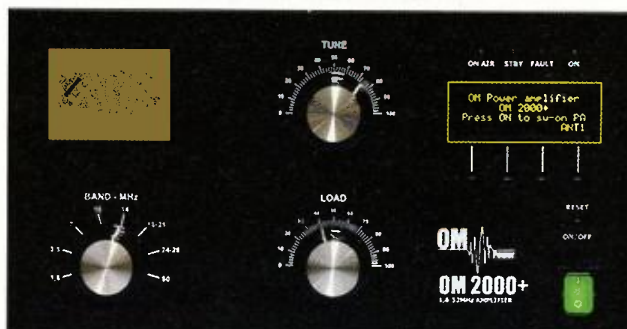
Obr. 1 a 2. Přední panel nového koncového zesilovače OM2000 (vlevo); vpravo pohled na vnitřní uspořádání
