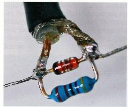
Obr. 2. Praktické provedení s 1N4148 pro 2,4 GHz
