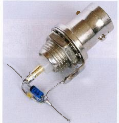
Obr. 3. Praktické provedení s konektorem a 1N5711 pro 5,2 GHz
