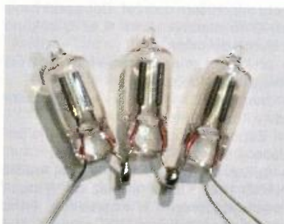
Obr. 3. Detail doutnavek zapojených v sérii
